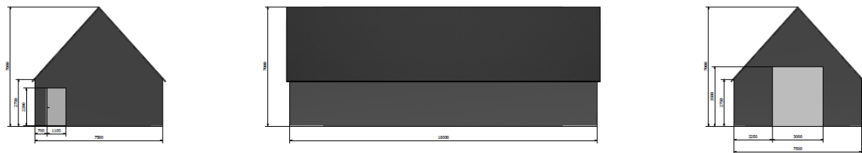
Figur 3. Facade tegninger af stålhal.
